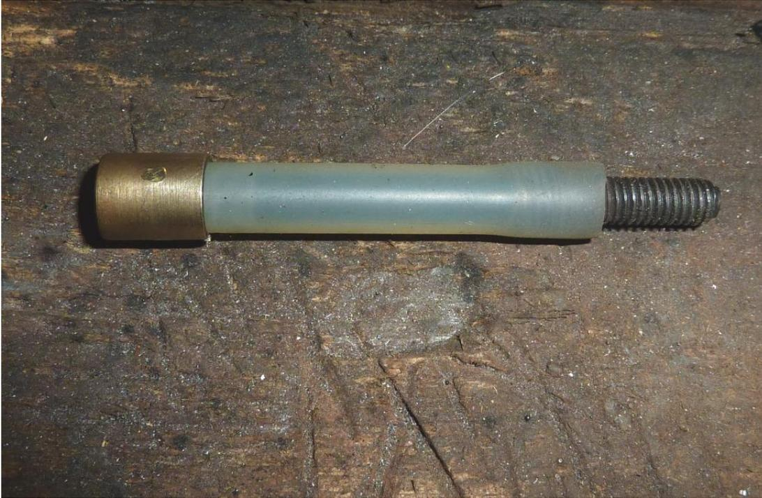
Le bout de filetage est serré dans le mandrin et l'autre bout est emmanché sur la queue de soupape ; La bague laiton permet de serrer suffisamment le tube silicone pour qu'il ne s'arrache pas de la queue pendant le rodage.
