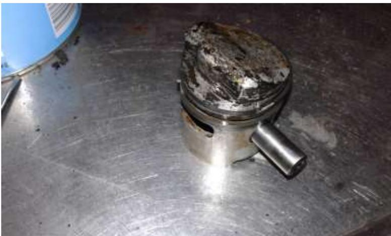
Mettre l'ensemble piston/segments/axe en place sur le pied de bielle –**ATTENTION, de ne pas faire bouger les rondelles de maintien des aiguilles et ATTENTION au sens de montage du piston (La flèche rouge ci-dessous vous montre le sens de circulation des gaz d'échappement)**
