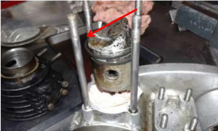
Remontez les circlips de maintien de l'axe de piston (oreille des circlips vers le bas). Maintenant que tout est remonté, vous pouvez retirer le chiffon.
