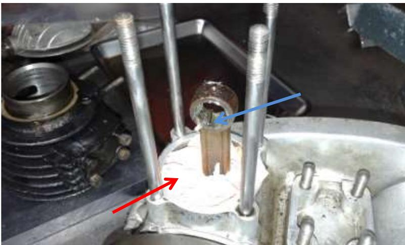
Remonter une à une les aiguilles (19) dans l'alésage du pied de bielle.
