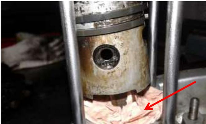
Remontez le joint d'embase sur le cylindre. Remontez le cylindre (**ATTENTION au sens de montage**)
