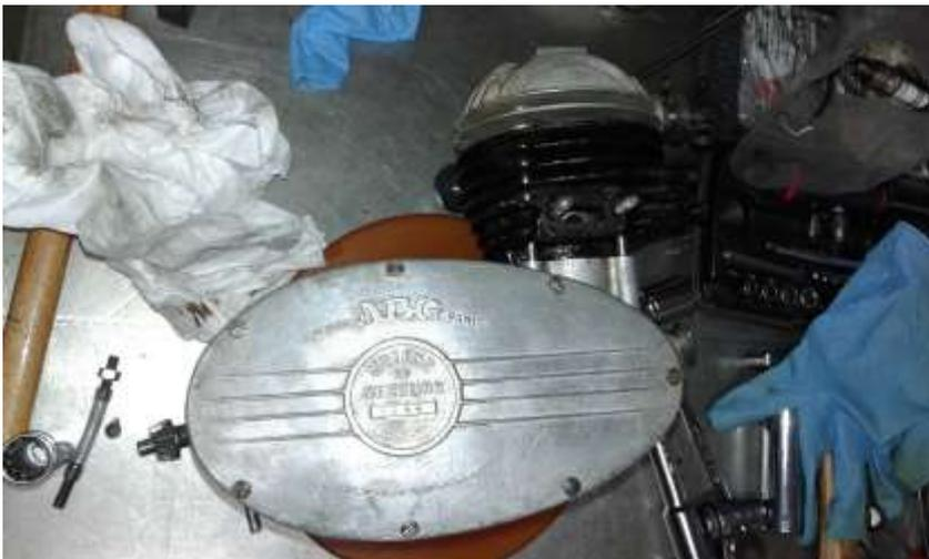
14- Remonter l'échappement, la pipe, le bras amortisseur, le capot de magnéto.
