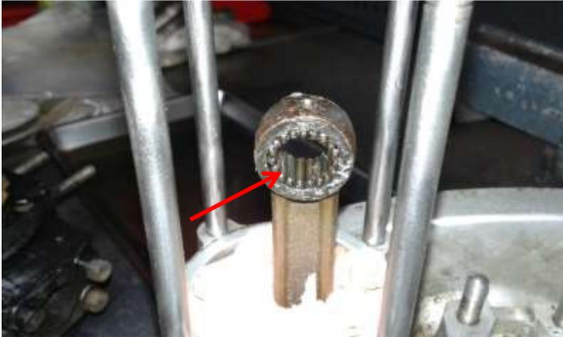
Remonter les 2 rondelles de maintien d'aiguille (un peu de graisse sur les rondelles pour les maintenir en place)
