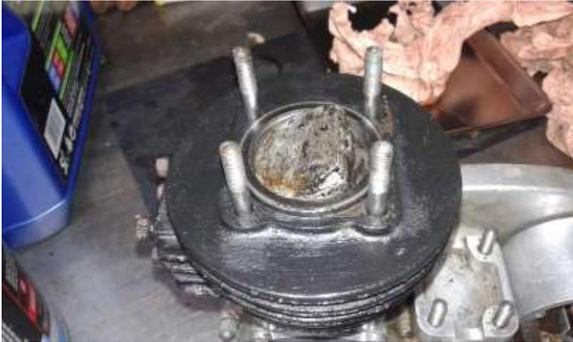
Remontez la culasse, Attention au sens de montage (Décompresseur au-dessus de l'échappement). Serrez la culasse en croisant le serrage.
