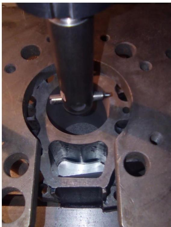
Réduction de la hauteur de cylindre (pour cause de hauteur de piston plus faible de 2,5mm.)
