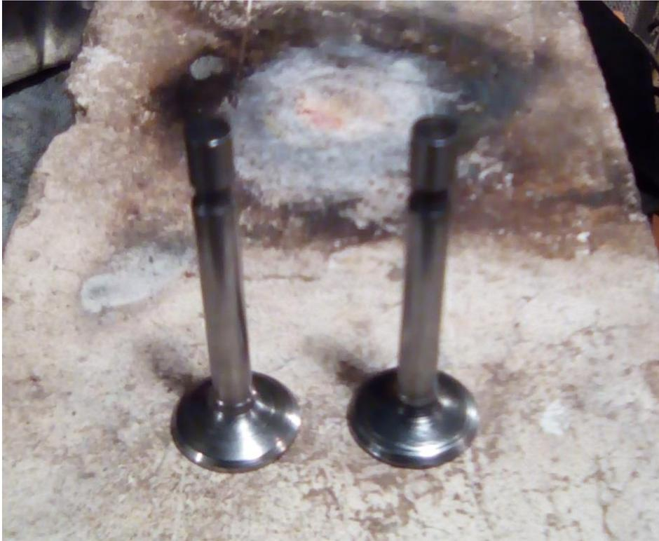
Les queues de soupapes font 2,5mm de plus que celles d'origines : pour permettre aux culbuteurs de travailler en position horizontale : Car cylindre = -2,5mm et je ne modifie pas les tiges des culbuteurs.
