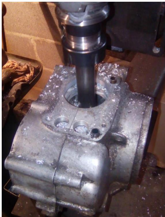
Alésage du cylindre en diamètre 44mm
