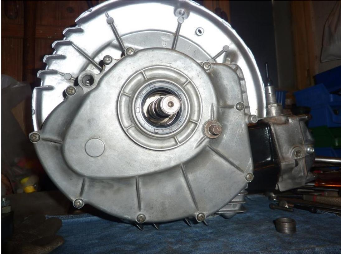
Montage du moyeu de roue et freinage : Les garnitures sont vraiment spécifiques (inversées) : elles viennent serrer le moyeu lorsque l'on freine.
