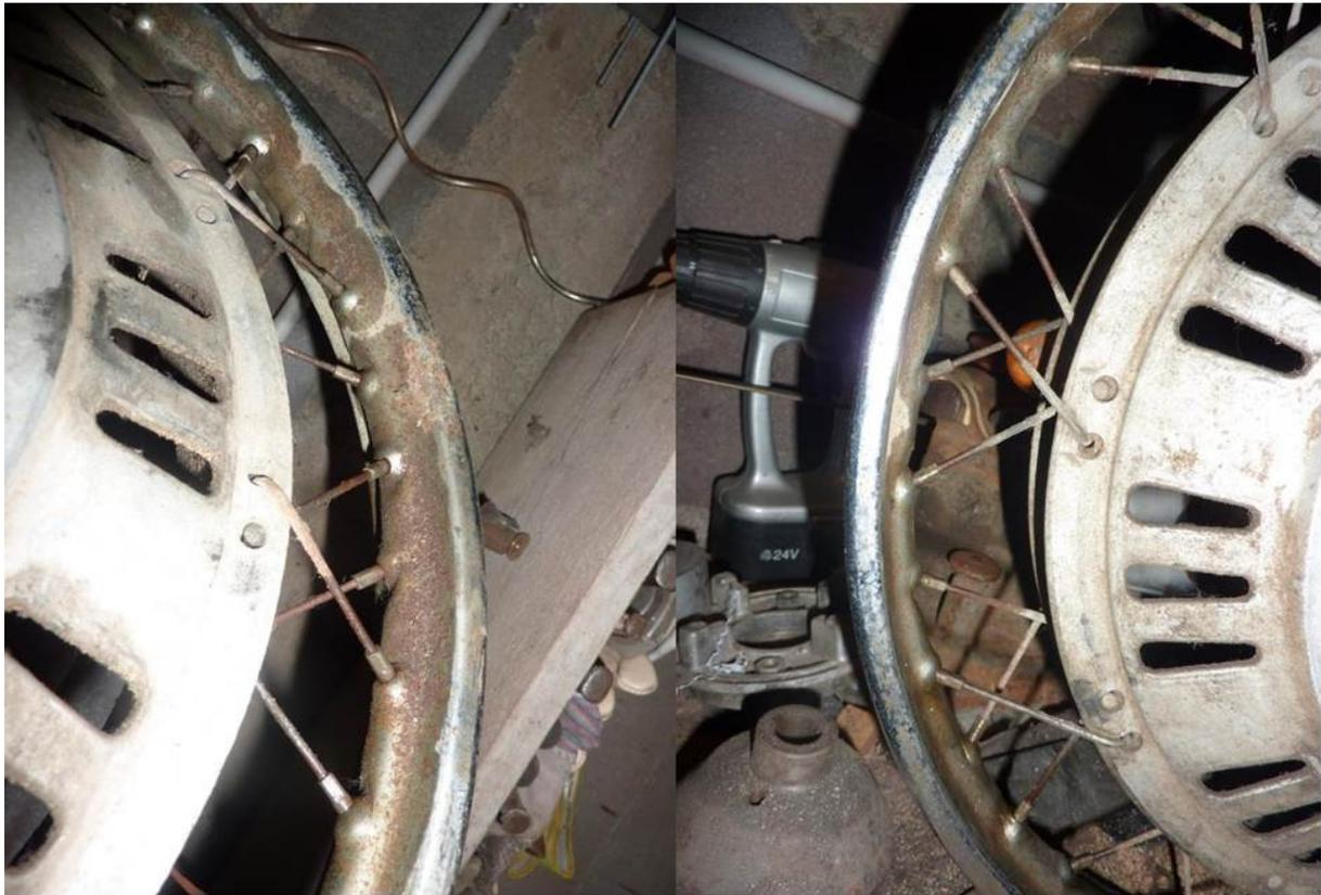
Y'a du boulot surtout que le moteur a été vidangé il y a plusieurs décennies et donc à peu près tout est rouillé à l'intérieur : vile, les chaînes de transmission et roulements... de plus le moteur à beaucoup roulé et les soupapes sont usées ainsi que cylindre et piston.
