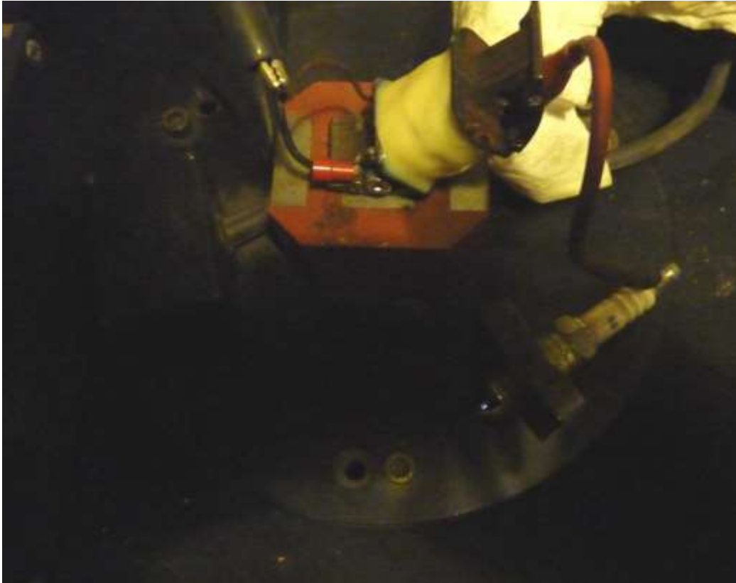
Le banc en action on voit facilement l'étincelle à la bougie
