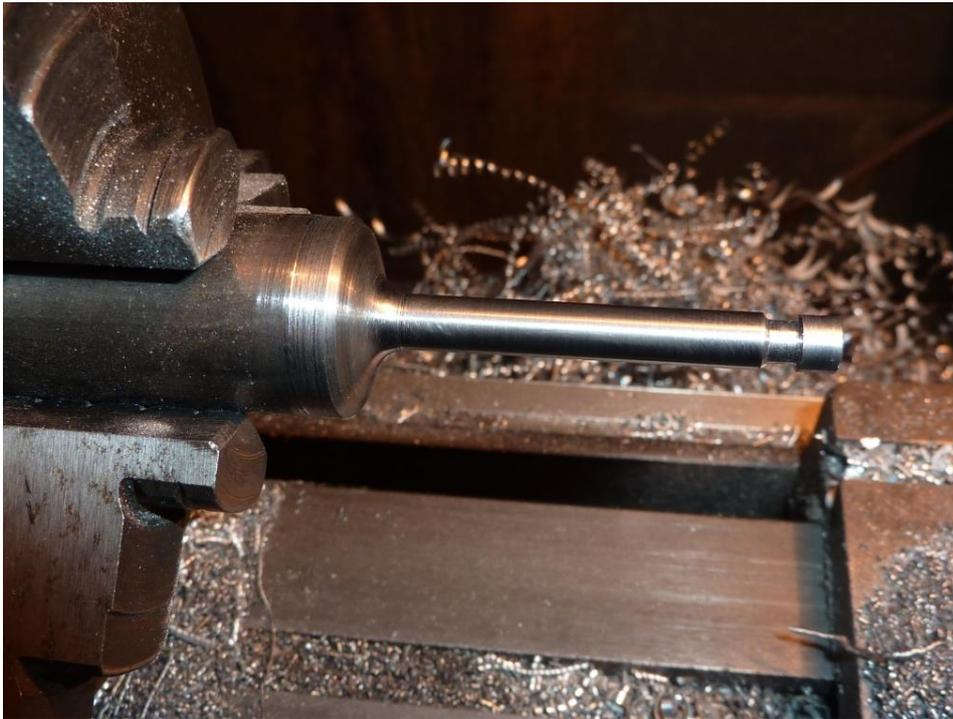
La soupape d'admission terminée : diam 20mm. C'est celle du milieu ; celle de droite à subit une trempe un peu sévère et c'est fendue !
