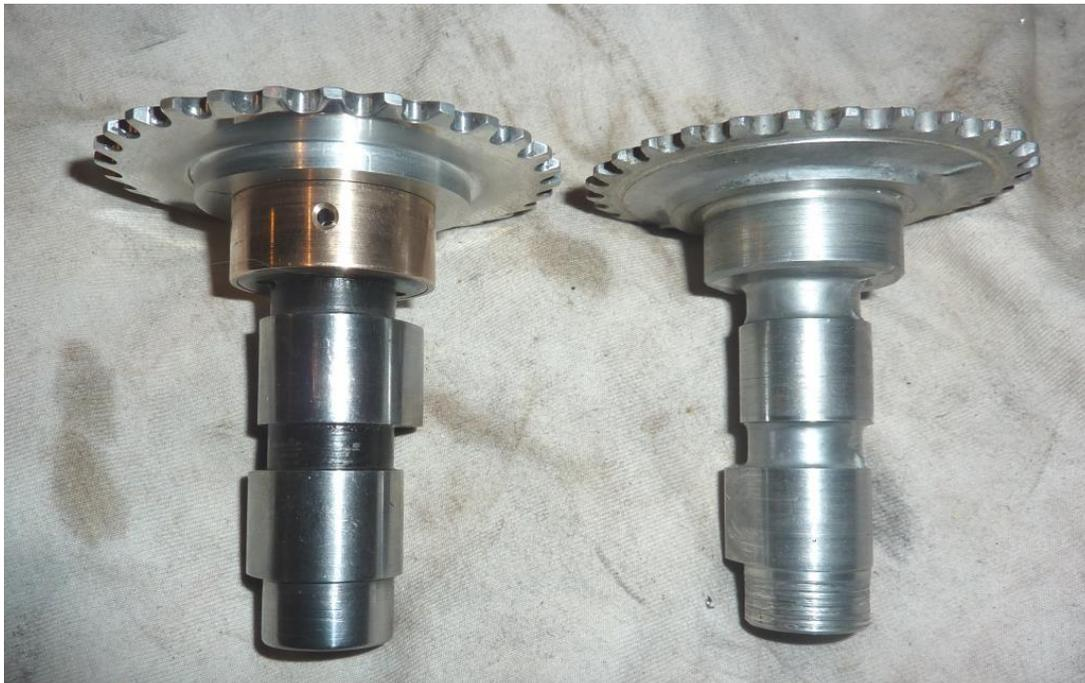
L'arbre à came monté sur le moteur
