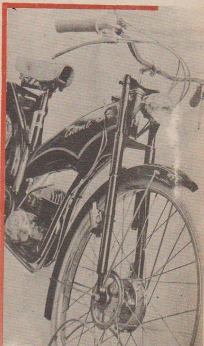
Parmi toutes les façons de monter un moteur auxiliaire, notons celle originale (ci-contre) d'un moteur hollandais sur le moyeu de la roue avant. Ci-dessous : le moteur arrière Cyclex.
