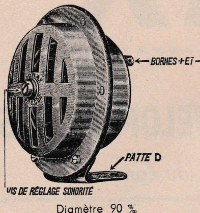
Fonctionne sur tous les vélomoteurs possédant un volant magnétique 6 volts ou 12 volts de 25 à 40 watts, car sa consommation est seulement de 1 ampère 5 à 3.000 tours.
